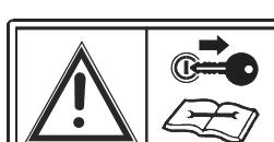
Retirer la clé de contact avant de procéder à tous travaux d'entretien ou de réparation !
